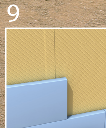
9 Szigetelést védő réteg / geotextília és hőszigetelő táblák
