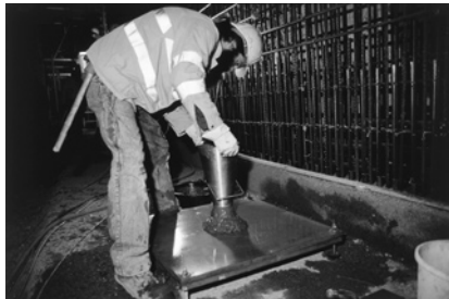
13. fotó: Öntömörödő beton vizsgálata
